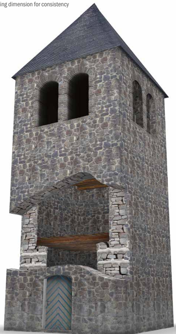
Verbindung abgelöster Mauerwerkschalen Connection of separated wythes
