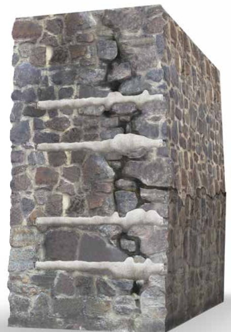
Abb. 4 Anbindung abgelöster Mauerwerkschalen | Connection of separated wythes
