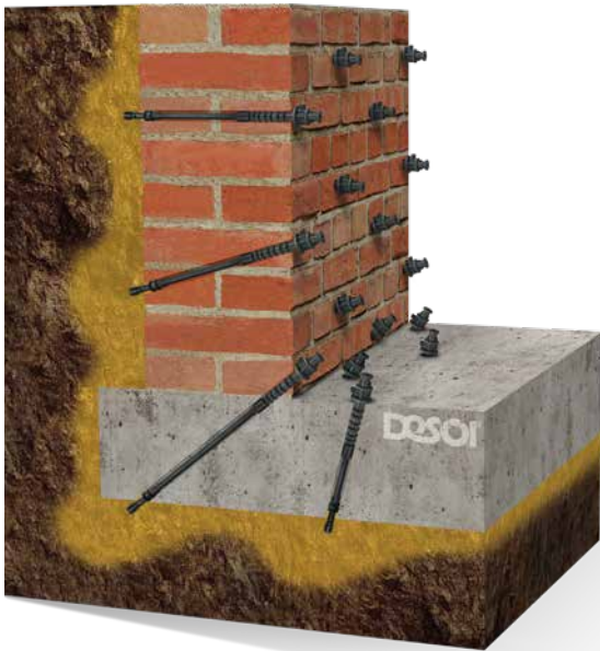
Schleierinjektion | Curtain injection
