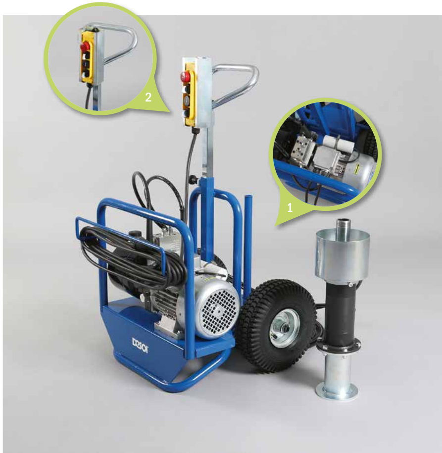
1. Bedienelement | Operating element 2. Umschaltautomatik | Automatic switching
